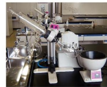
▲ロータリーエバポレータ 多用途に対応できる濃縮装置。多種分析の前処理、溶媒の分離・精製、抽出溶媒の除去、試料の乾燥・脱水に使用。
