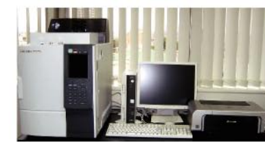
▲ガスクロマトグラフ 試料をガス化して分離分析、主に脂肪酸などを分析。
