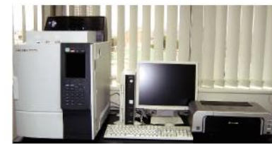
▲ガスクロマトグラフ 試料をガス化して分離分析、主に脂肪酸などを分析。
