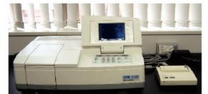
▲分光光度計 応用範囲が極めて広い分析装置で溶液試料についてはスペクトル測定による試料の同定や、化合物の電子状態の研究などほとんどの陽イオン、陰イオンの定量分析に利用できます。
