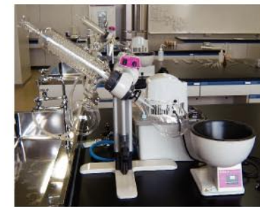
▲ロータリーエバポレータ 多用途に対応できる濃縮装置。多種分析の前処理、溶媒の分離・精製、抽出溶媒の除去、試料の乾燥・脱水に使用。
